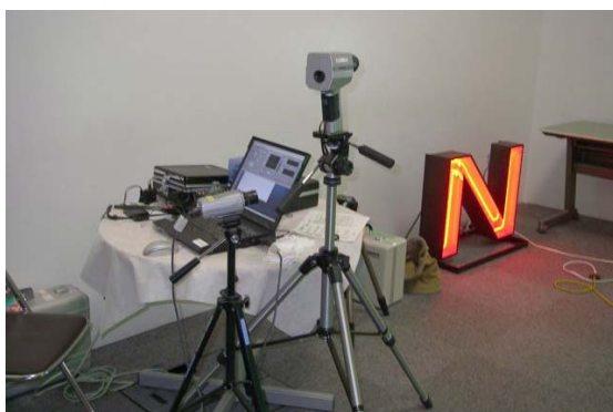
写真 5 輝度測定機器
